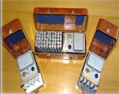
Предназначены для контроля экспозиционных доз гамма-облучения, получаемых людьми при работе на зараженной радиоактивными веществами местности или при работе с открытыми и закрытыми источниками ионизирующих излучений.
