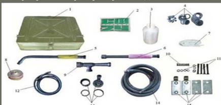
**Состав комплекта ДК-4К:** 1 – ящик; 2 – пакет с порошком СФ-2У (СФ-2); 3 – банка полиэтиленовая; 4 – запасные части; 5 – брандспойт; 6 – удлинитель; 7 – ветошь; 8 – щетка; 9 – эжектор; 10 – пружина; 11 – крепежные детали; 12 – рукав жидкостный; 13 – газоотборное устройство; 14 – рукав газожидкостный; 15 – крючок и планка.
