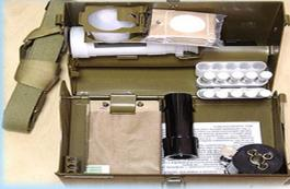
Принцип работы ВПХР заключается в следующем: при прокачивании через индикаторные трубки анализируемого воздуха в случае наличия ОБ происходит изменение окраски наполнителя трубок. Сравнивая окраску наполнителя трубки с эталоном, изображенным на кассете, делается вывод о чрезмерной концентрации ОБ.
